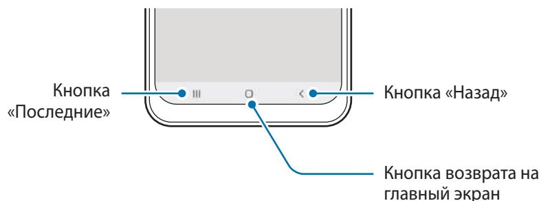
После включения устройства внизу экрана появляются программные кнопки. Дополнительные сведения см. в разделе [Навигационная панель \(программные кнопки\)](#).
